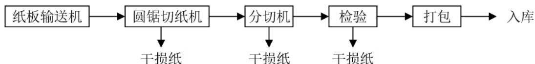
图 2.1-3 整饰工段工艺流程及产污环节图
