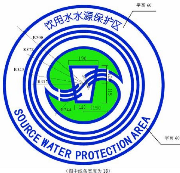
图 4-2 饮用水水源保护区图形标志尺寸比例示意图
