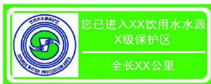
图4-5饮用水水源保护区道路警示牌示意图（高速公路）
